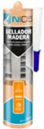
Sellador elástico para todo tipo de madera. Para juntas entre piezas o madera a obra. No ennegrece, no desprende olores y se limpia con agua. Apto para uso interior y exterior. Barnizable y pintable.
